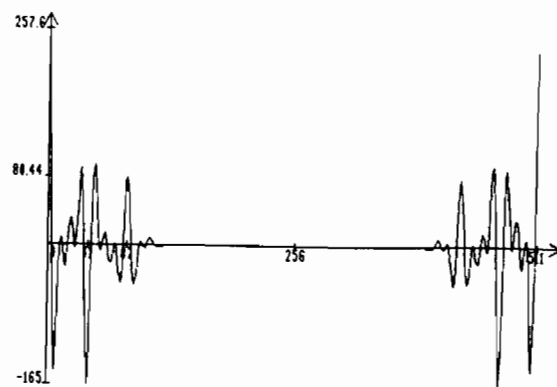
AUTOCORRELATION DU SIGNAL : LARGEUR D'ECHO = ECART ENTRE ECHOS
