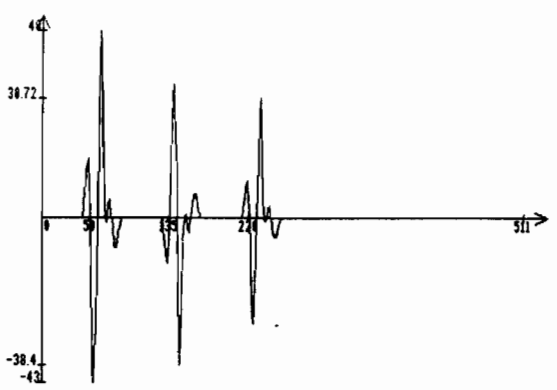
SIGNAL A STRUCTURE D'ECHOS SIMULE: 85 ECHANTILLONS ENTRE 2 ECHOS SUCCESSIFS
