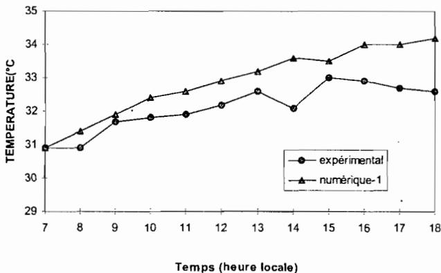
**Figure 6.b :** Comparaison valeurs expérimentale et théorique pour un modèle unidimensionnel (case ouverte)
