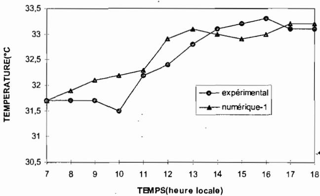
**Figure 6.a :** Comparaison valeurs expérimentale et théorique pour un modèle unidimensionnel (case fermée)
