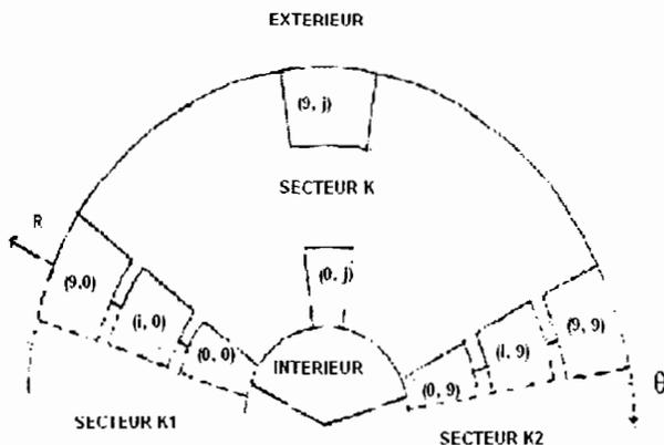
Figure 5 : Volume de contrôle pour une modélisation bidimensionnelle.
